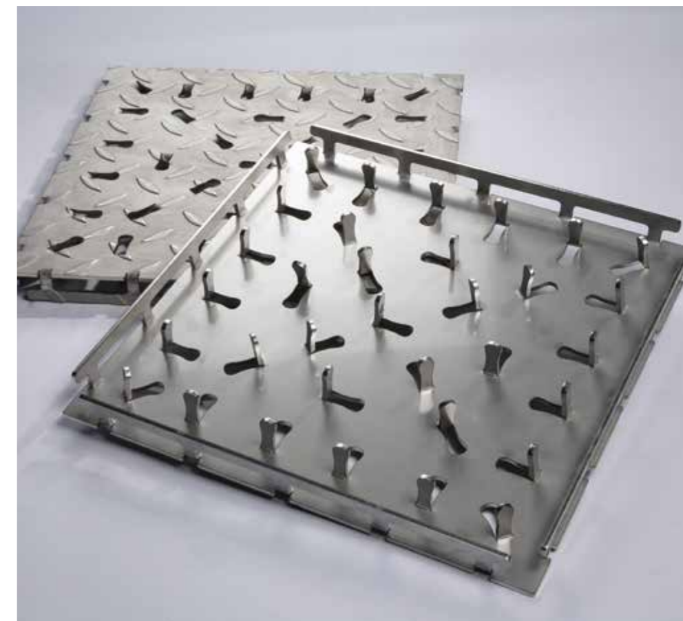
Código del Producto: DPK300-03003003 Azulejo Inoxidable de Superficie Antideslizante AISI 304 L 300x300x3-4 mm.
